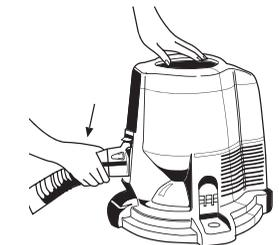
**5** По завершении электрических соединений поставьте переключатель ON/OFF (ВКЛ/ВЫКЛ) пылесоса Rainbow на «высокую скорость» (high speed, >>), чтобы использовать как пылесос Rainbow, так и насадку Power Nozzle. Рычажок сетевого выключателя на рукоятке электрифицированного шланга управляет только насадкой Power Nozzle. Чтобы отсоединить электрифицированный шланг от силового блока, сожмите фиксаторы и выньте шланг из патрубка впускного отверстия.
