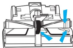
**5** Убедившись, что ремень надет на ось электродвигателя и шкив по центру валика щетки, поместите края валика на направляющие, расположенные с внешних краев корпуса насадки. Обеими руками продвиньте валик по направляющим к передней части корпуса, пока края валика полностью не сядут в свои пазы. Проверните валик щетки вручную, чтобы ремень вошел в сцепление с канавкой, имеющейся посередине шкива.
