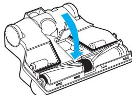
**3** Чтобы снять валик щетки, возьмите его за края и выньте из пазов в корпусе насадки. Снимите изношенный или лопнувший ремень с валика щетки или оси электродвигателя.
