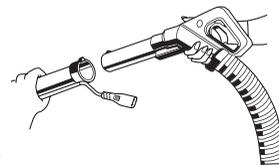
**2 ВЫПОЛНЕНИЕ ЭЛЕКТРИЧЕСКИХ СОЕДИНЕНИЙ:** Крепко удерживая шланг (и не прижимая при этом рычажок сетевого выключателя), вставьте вилку сетевого шнура насадки Power Nozzle в гнездо, расположенное с нижней стороны рукоятки Rainbow.
