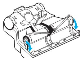
**6** Поверните крышку ремня по направлению к передней части корпуса и надавите, чтобы она вновь зафиксировалась.
