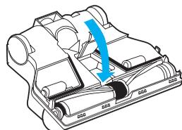
**7** Расположите нижнюю крышку поверх корпуса насадки. Надавите ее, чтобы она встала на место, и поверните фиксатор на четверть оборота вправо (по часовой стрелке) до щелчка.
