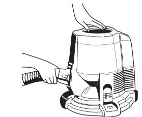
**4 ПОДАЧА ПИТАНИЯ НА НАСАДКУ POWER NOZZLE:** После завершения электрических соединений главный сетевой переключатель на силовом блоке будет подавать питание как на пылесос, так и на насадку Power Nozzle. Однако щетка насадки этим переключателем не включится. Для этого необходимо прижать рычажок сетевого выключателя на рукоятке Rainbow. Чтобы отсоединить электрифицированный шланг от силового блока, сожмите фиксаторы и выньте шланг из патрубка впускного отверстия.
