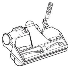
**2** Просуньте палец под крышку ремня в районе щетки. Приподнимите крышку, чтобы она расфиксировалась, а затем поверните назад, по направлению к жесткому переходнику.
