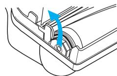
**4** Наденьте новый ремень на шкив, находящийся по центру валика щетки. Расположите валик над блоком так, чтобы индикаторный паз находился ближе всего к ячейке запасного ремня, а ремень свисал с валика щетки у оси электродвигателя. Наденьте ремень на ось двигателя.
