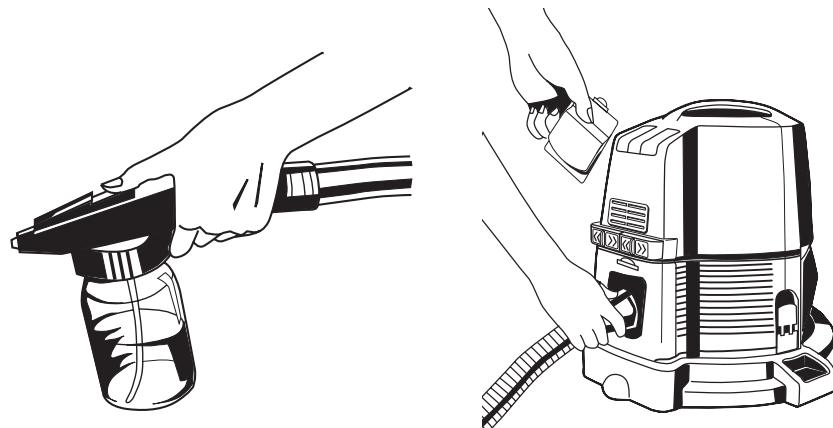
**УЗЕЛ РАСПЫЛИТЕЛЯ:** Распылитель подключается к шлангу пылесоса Rainbow и используется для разбрызгивания средств от насекомых, растворов от моли, и т.д. Кроме того, он может использоваться для внесения жидких удобрений или полива комнатных растений. Для применения распылителя просто наденьте его на изогнутую рукоятку штанги и подсоедините шланг к выпускному патрубку пылесоса Rainbow.
