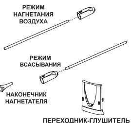
**Переходник-глушитель Rainbow** используется для снижения шума воздуха, проходящего через воздухоприемник. Применение этого переходника рекомендуется при работе пылесоса в режиме нагнетания воздуха. Просто наденьте его на воздухоприемник перед использованием пылесоса Rainbow в качестве нагнетателя.
